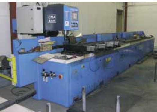
Jopa 7,5 m pitkien aihoiden poraus ja kierteitys voidaan suorittaa automaattisesti CMA NC-poraus- ja kierteitysautomaatilla ennen tai jälkeen taivutuksen.
